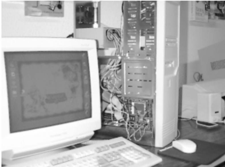
Un processeur **Pentium 133**, une mémoire de 32 Mo, un lecteur CD Rom sextuple vitesse, des disques durs d'une capacité totale de 1,5 Go, une carte **SoundBlaster 32 bits** et deux hauts-parleurs de 85W. Vous y ajoutez un écran 17 pouces, un modem 28.800 bauds, une imprimante couleur **Epson Stylus color** et une unité de sauvegarde Iomega Zip. Une bonne dose de logiciels et voici une machine pour satisfaire les adhérents les plus exigeants.
