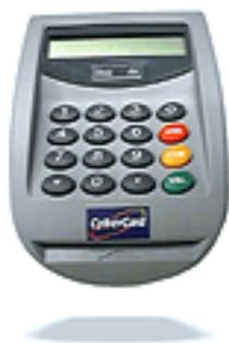
Ce système nécessitait un lecteur sécurisé fabriqué par Bull. C'est une sorte de TPE qui se connectait sur le port série du PC ou du Macintosh.
