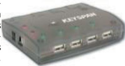
On peut connecter jusqu'à 127 périphériques sur les ports USB. Quand le nombre de connecteurs disponibles est insuffisant on utilise des HUBs (ou concentrateurs).
