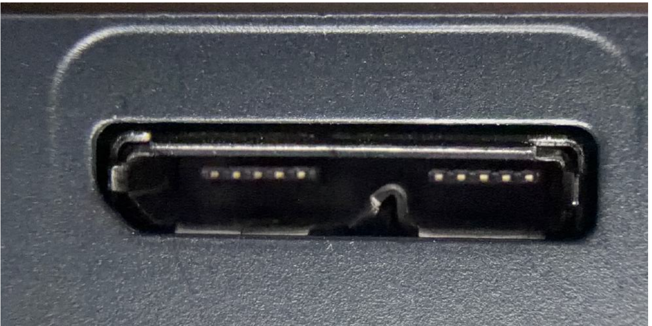
Zoom sur le connecteur USB3 sur un disque.
