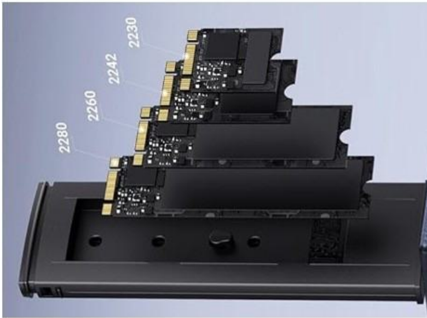
Il existe plusieurs types de disques NVMe de différentes tailles.
