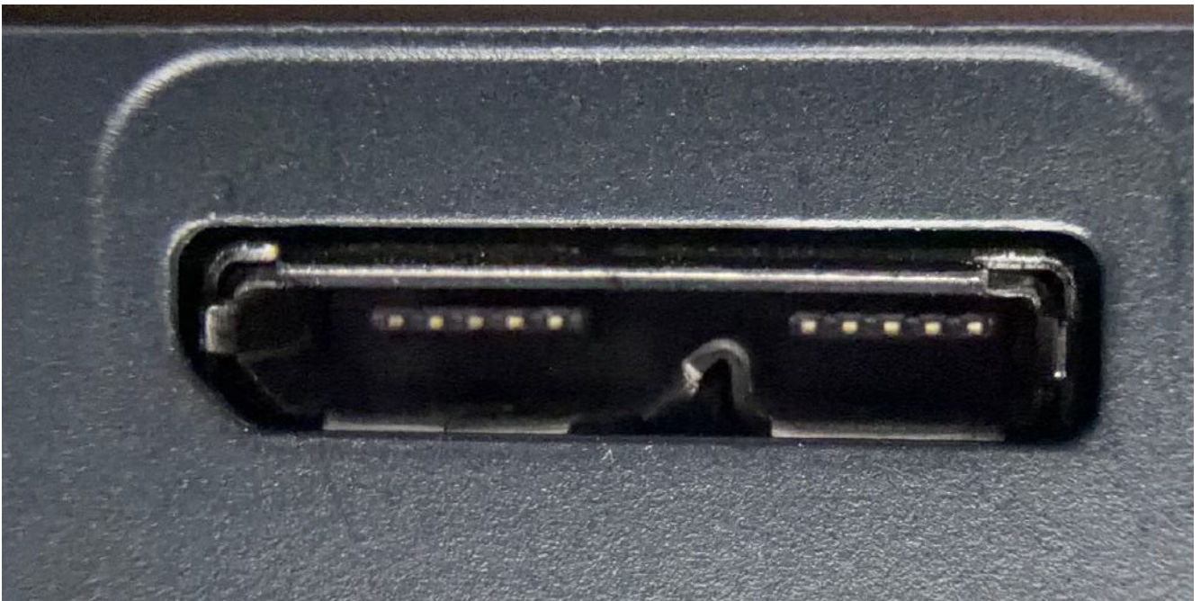
Nahaufnahme des USB-3-Anschlusses an einer Festplatte.
