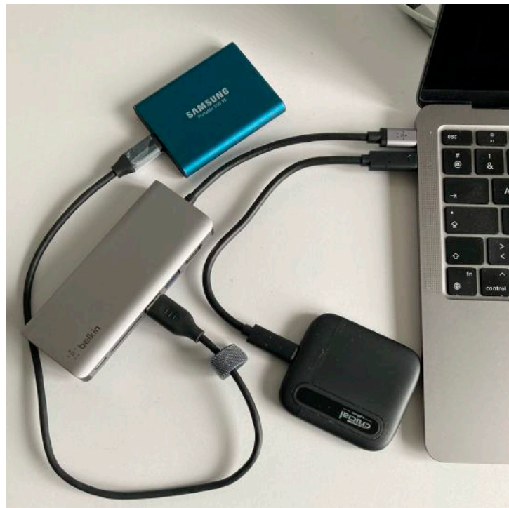
T7-Laufwerk über einen Hub angeschlossen und Crucial-SSD an einen Port des MacBook angeschlossen.
