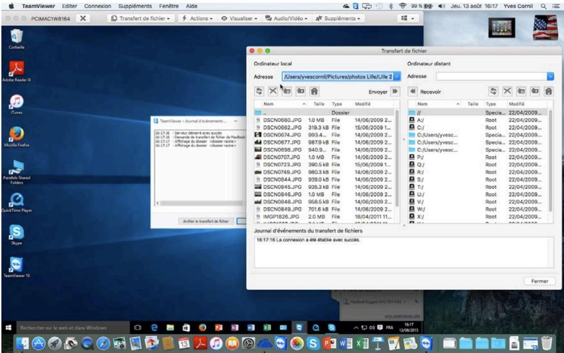
Dans la fenêtre transfert à gauche on a la partie Mac et à droite on a la partie PC.
